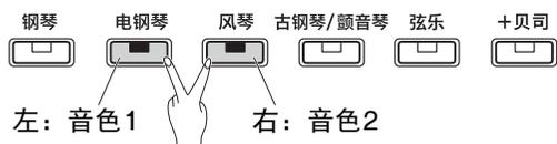
请注意，左侧按钮的音色将指定为音色1，右侧按钮的音色将指定为音色2。替代音色指示灯显示音色1的状态。
