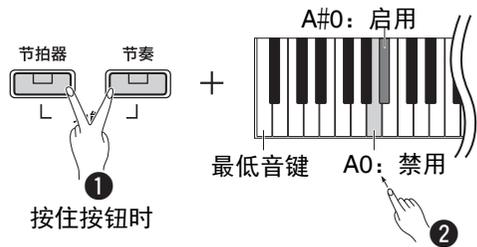
当电源关闭时，在按住最低音键的同时打开电源，可以禁用自动关机。[●]（录音）指示灯闪烁三次，表示自动关机功能已禁用。
