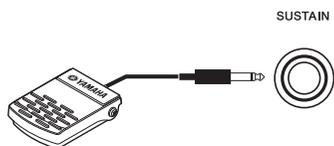
在演奏的同时踩下已插入[SUSTAIN]（延音）插孔的踏板开关，可以产生自然的延音。同时，选购的FC4A或FC5踏板开关也可连接至该插孔。
