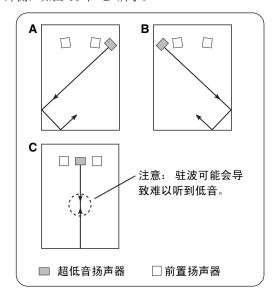
如图 **C** 所示的摆放位置也是可以的。但是,如果超低音扬声器直接面对墙壁放置,而聆听位置处于房间中央,则可能无法听到完美的低音效果。这是因为在两面平行的墙壁之间形成了「驻波」,从而会抵消低音音效。为了防止出现这种情况,应使超低音扬声器斜对墙壁放置。有时可能还需要靠墙壁放置书架等等,以此打破平行墙面的完整性。
