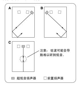
如图 **C** 所示的摆放位置也是可以的。但是,如果超低音扬声器直接面对墙壁放置,而聆听位置处于房间中央,则可能无法听到完美的低音效果。这是因为在两面平行的墙壁之间形成了「驻波」,从而会抵消低音音效。为了防止出现这种情况,应使超低音扬声器斜对墙壁放置。有时可能还需要靠墙壁放置书架等等,以此打破平行墙面的完整性。
