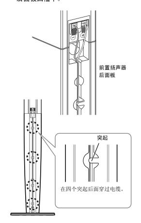
**2** 电缆向下至底座放入到位后,将电缆穿过底座上的孔。从底座底部轻轻拉动电缆,并穿过底座上的凹口。
