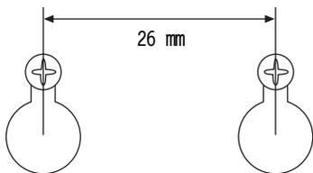
按照下图所示固定螺钉到坚固的墙壁上或墙支撑上，在突出的螺钉上悬挂孔。
